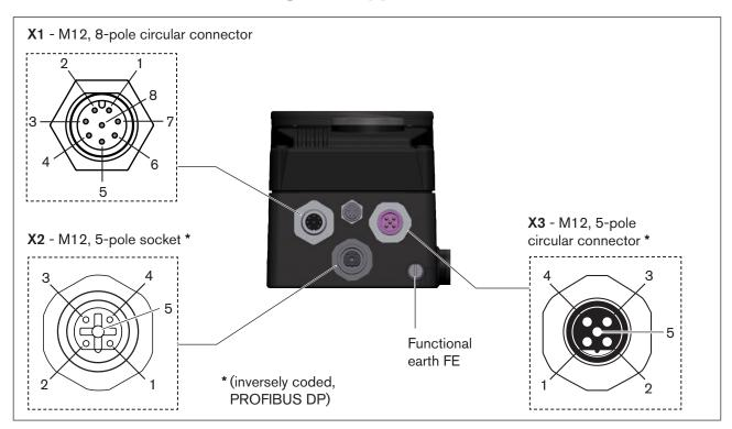
Figure 107: Connection PROFIBUS DP, positioner Typ EP 501
